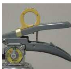
× レバー支えの脱落
