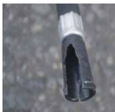
× ノズルの破損
