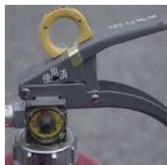
× 表示装置の脱落
