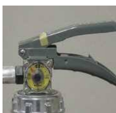
× 安全栓の脱落
