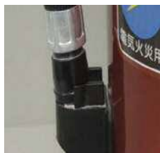
× 消火薬剤の漏れ
