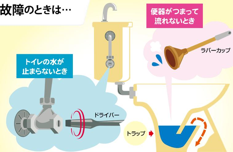
トイレ使用後に水が止まらなかったり、便器にいつもちょろちょろと水が流れている場合は、タンク給水管についている「止水せん」をドライバーで閉めて水を止めてください。次にタンク内の鎖・フロート弁などを調べ、修理が必要なら指定工事に依頼してください。
