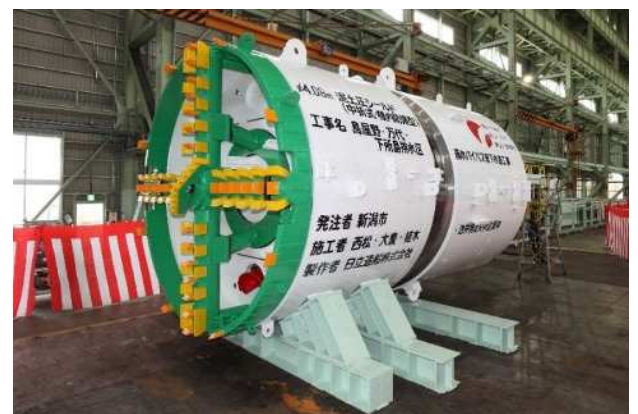
地中を掘進するシールドマシン
