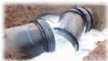
東北地方太平洋沖地震による送水管の抜け出し (φ2400mm) (宮城県) 出典：厚生労働省
