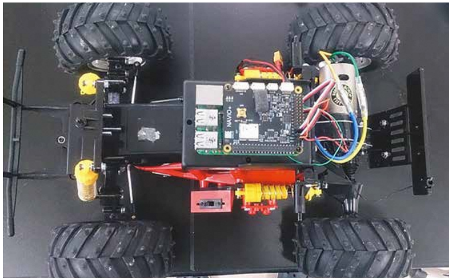
図3.5 自律航行装置を搭載したラジコンカー
